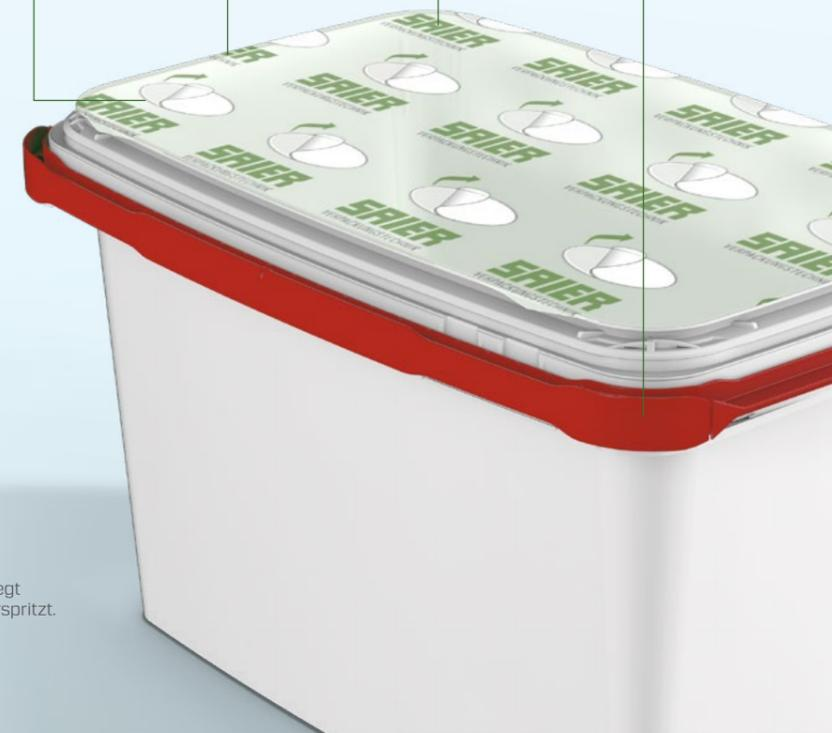
\* IML steht für In-Mould Label. Beim IML-Verfahren wird eine im Flachdruck dekorierte Kunststoffolie in ein Spritzwerkzeug eingelegt und mit einem thermoplastischen Kunststoff-Matrixmaterial hinterspritzt. Die Folie verbindet sich dadurch mit dem Matrixmaterial.
